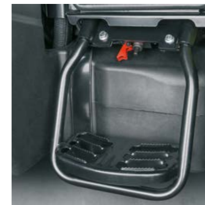
Lo stacca batteria è facilmente raggiungibile a sinistra della scaletta d'accesso (tranne per l'ELIOS 210).
