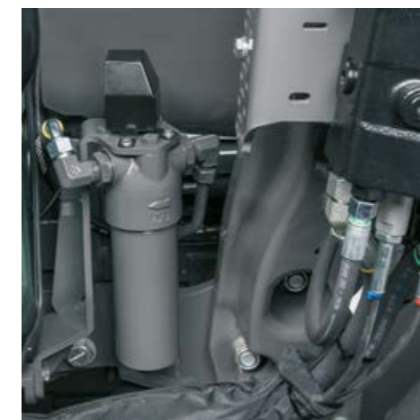
I filtri sul motore sono facilmente raggiungibili anche con i telai del caricatore frontale montati.
