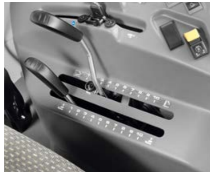
Il comando del dispositivo di regolazione meccanico del sollevatore posteriore è posizionato in modo ergonomico a destra del sedile dell'operatore.
