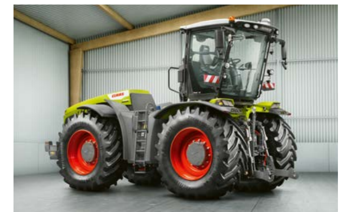
Il TRAC VC è dotato del sistema di guida reversibile più comodo disponibile sul mercato. La cabina può essere ruotata di 180° in meno di 30 secondi.
